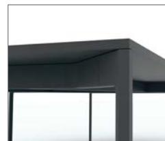
**QUERTRÄGER:** Rechteckiges E220 Stahlrohr in den Abmessungen 70 x 40 x 1,5 mm, heißgewalzt und dekapiert, mit Epoxidharzbeschichtung mit einer Dicke von 100 Mikron. Die Verbindung zwischen dem Querträger und der Säulenkonstruktion erfolgt über ein Kunststoffelement, das die Montage erleichtert und ein attraktives äußeres Erscheinungsbild bietet. Lasergeschnittenes Verbindungselement.
