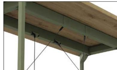
**FUßSTÜTZEN FÜR HOHE TISCHE:** Struktur aus Stahlrohren 50 x 30 x 2 mm und 40 x 20 x 2 mm mit doppeltem Anstrich (Epoxidfarbe plus Lack), der die Reibungs- und Verschleißfestigkeit erhöht. Er wird an den Aluminiumbeinen befestigt und dient als Verankerung für die Spannseile, die die Tischstruktur versteifen.
