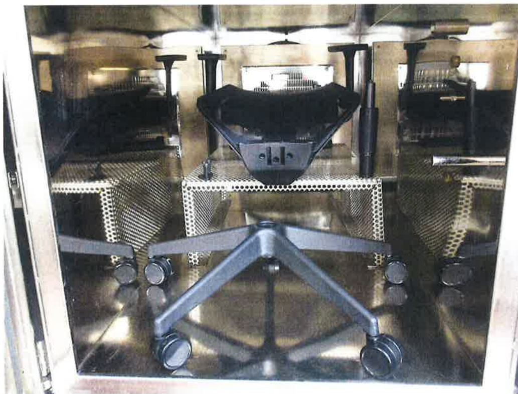
Eprouvette conditionnée dans la chambre d'essai d'émission / Test piece in emission test chamber
