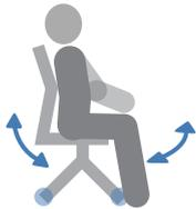
Le mouvement 3.60 partage avec ces boules l'équilibre instable produit par la libération du système d'équilibrage latéral dynamique qui permet à l'ensemble assise/dossier/accoudoir d'osciller librement avec un effet de rotule sphérique. Il apporte également d'autres éléments à prendre en compte :
