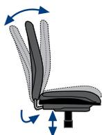
**SINCRO ATOM:** rotation du dossier par rapport à l'assise sur un axe situé en haut de la surface de l'assise, au niveau des hanches de l'utilisateur assis, qui assure soutien et accompagnement maximal au cours du mouvement d'inclinaison. Auto-pesant et conçu pour des personnes d'un poids oscillant entre 45 et 110 kg. Manette pour le blocage du dossier. En option, cinq positions de réglage en profondeur de l'assise.
