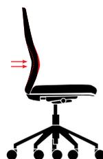
Beaucoup de sièges sont conçus pour tenir un appui adaptable dans le dos. Il est très recommandable que le dossier règle les mouvements avant et arrière, et est possible son blocage selon l'utilisateur. De plus, beaucoup de sièges incorporent un dispositif qui règle la courbure de la siège au dos et donne un meilleur repos pour l'employé.
