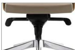
**BASCULANT OSCILO** : mécanisme basculant qui permet l'inclinaison du dossier avec un angle constant par rapport à l'assise. Angle de l'inclinaison jusqu'à 16°. 4 positions de blocage.
