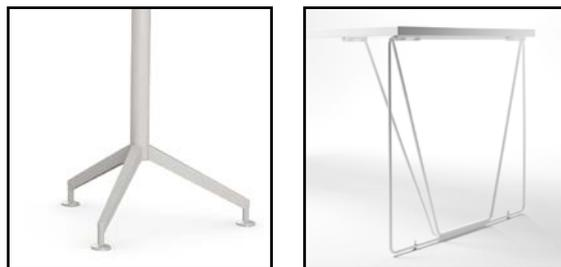
**MESAS CON PATA CABALLETE:** Estructura fija realizada en varilla maciza de acero de Ø 11 mm recubierta con pintura epoxi de 80 micras de espesor. La estructura con forma de marco rectangular, incorpora un tirante de apoyo a la tapa para rigidizar la mesa. Cada pedestal incorpora dos niveladores de aluminio para compensar pequeños desajustes en la superficie de apoyo.
